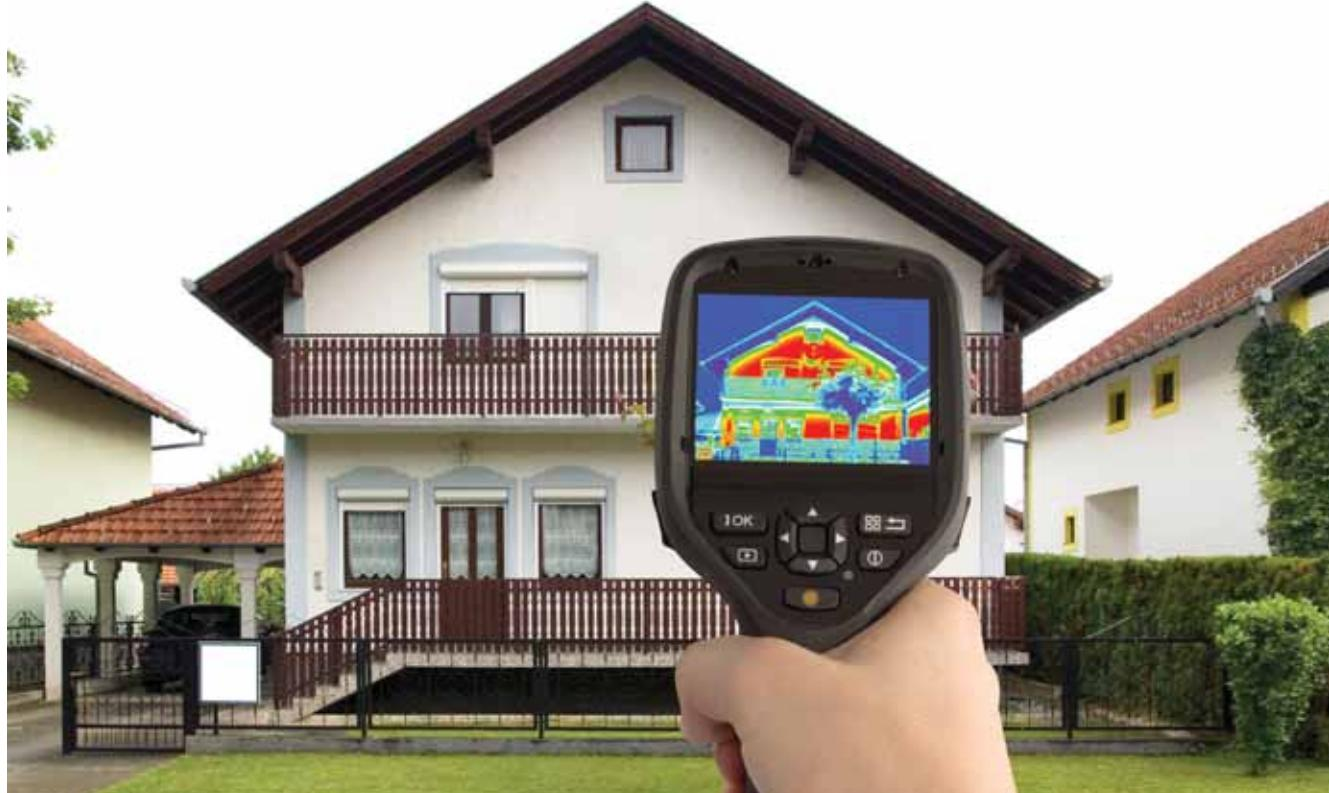
انرژی در ساختمان را در اصطلاح فنی U-VALUE می‌گویند که بر حسب واحد  $\text{W/m}^2\text{K}$  محاسبه می‌گردد. به عبارت ساده‌تر میزان هدررفت انرژی در یک سازه مشخص را با مقدار U-VALUE تعیین می‌نمایند که هرچقدر عدد بسته‌تر آمده کمتر باشد میزان هدررفت انرژی کمتر است.
