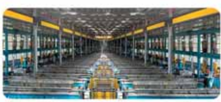
خط تولید پروفیلهای u.PVC با ۶۵ خط اکستروژن
