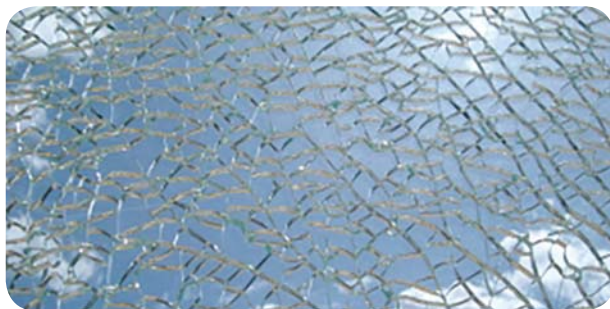
شکل ۱۹. نحوه شکسته شدن شیشه های سکوریت
