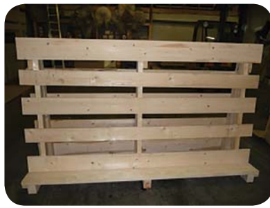
شکل ۲۱. نمونه‌ای از فریم‌های ساخته‌شده چوبی برای نگهداری شیشه
