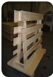
شکل ۲۱. نمونه‌ای از فریم‌های ساخته‌شده چوبی برای نگهداری شیشه
