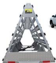
شکل ۲۲. نمونه‌ای از ماشین به‌همراه فریم طراحی‌شده برای حمل و نقل شیشه
