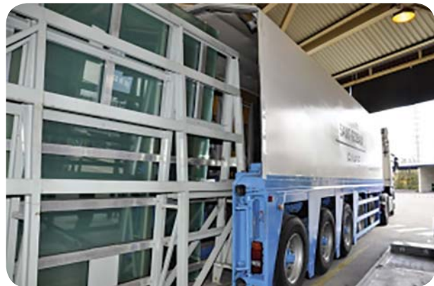
شکل ۲۳. برای حمل شیشه‌هایی با ابعاد بزرگ از تریلرهای ویژه استفاده می‌شود
