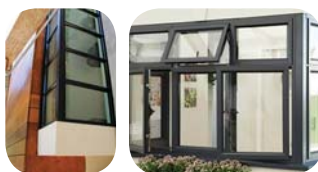
شکل ۱۲. پوشش‌های آندایز علاوه بر زیبایی و ایجاد رنگ‌های متنوع باعث مقاومت بیشتر در مقابل عوامل جوی نامناسب می‌گردد
