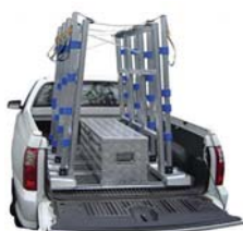
شکل ۲۲. نمونه‌ای از ماشین به‌همراه فریم طراحی‌شده برای حمل و نقل شیشه
