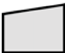
شکل ۲- پنجره دوزنقه‌ای به علت عدم برش صحیح
