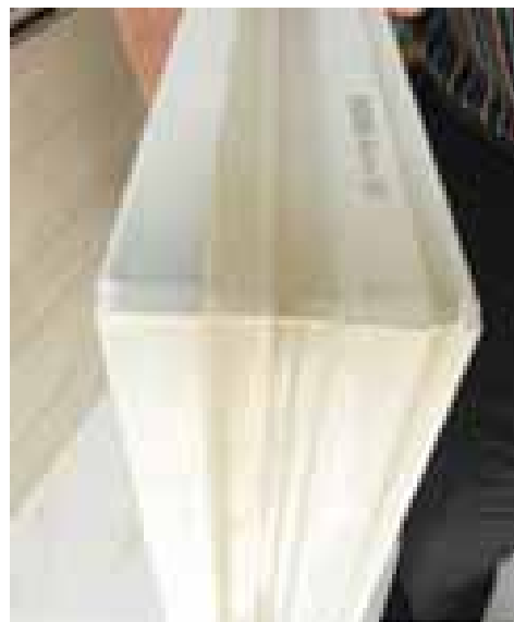
شکل ۱۵- تمیزکردن مناسب گوشه توسط تیغه
