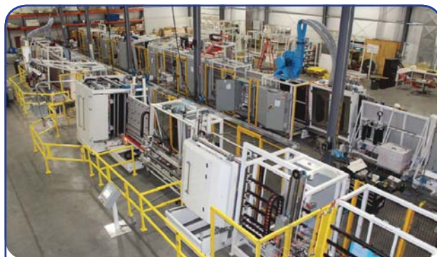
خط تولید سرعت بالای شیشه عایق شرکت اردمن (Erdman) در این خط تولید حفاظ‌های متعدد به منظور جلوگیری از هرگونه تماس با دستگاه، نصب شده است
