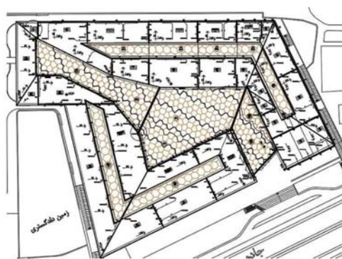
تصویر شماره ۱ - جانمایی اولیه گاترها بر مبنای محاسبات تأسیساتی
